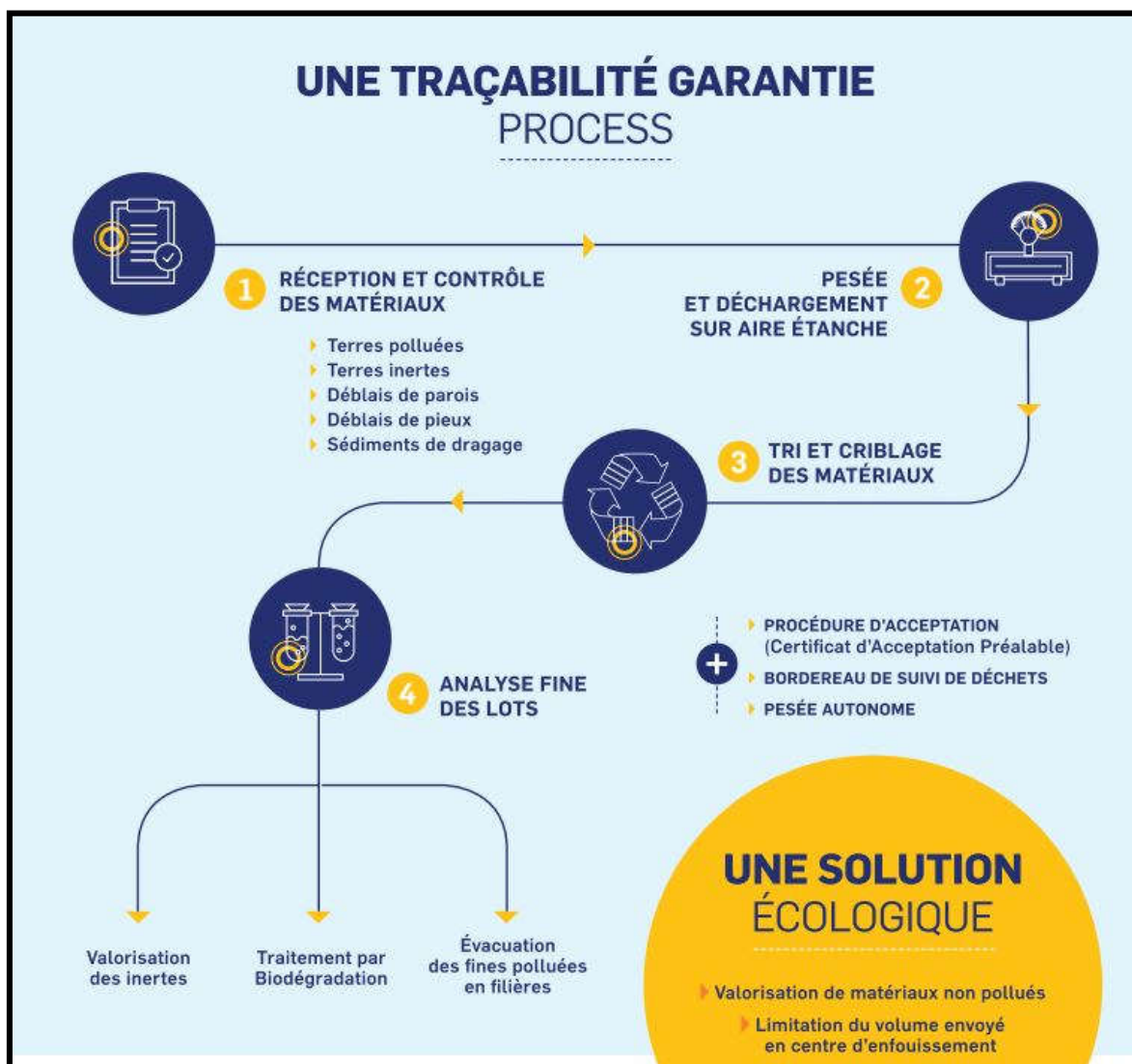
PROCEDE DE TRAITEMENT DES DECHETS Source : BREZILLON
